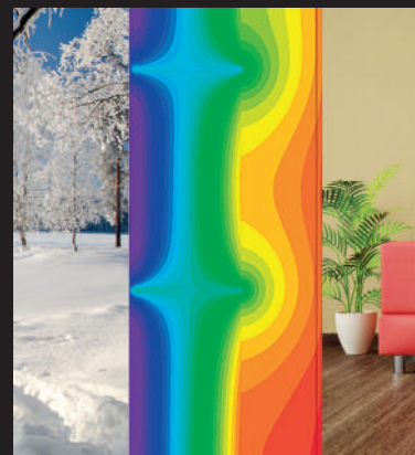
Izteikts aukstuma tilts ar alumīnija kronšteiniem
